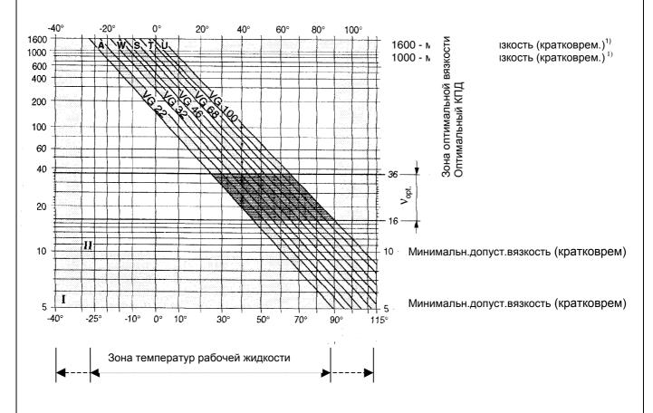
1) в зависимости от типа и номинального размера машин принимаются следующие диапазоны вязкости:
